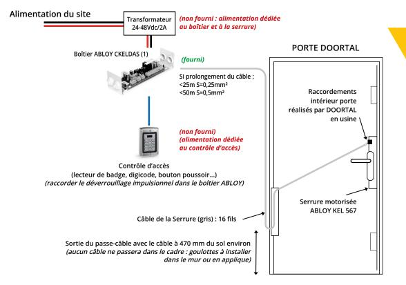
INFO : Le paramétrage de la serrure (émission ou rupture) peut être effectué sur demande par un technicien DOORTAL lors de la mise en service de la porte.
